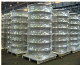
Рис. 10. Зберігання мідної труби в бухтах
