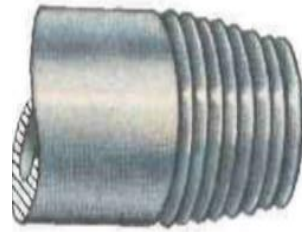
Рис 2. Різьба з конічною формою
