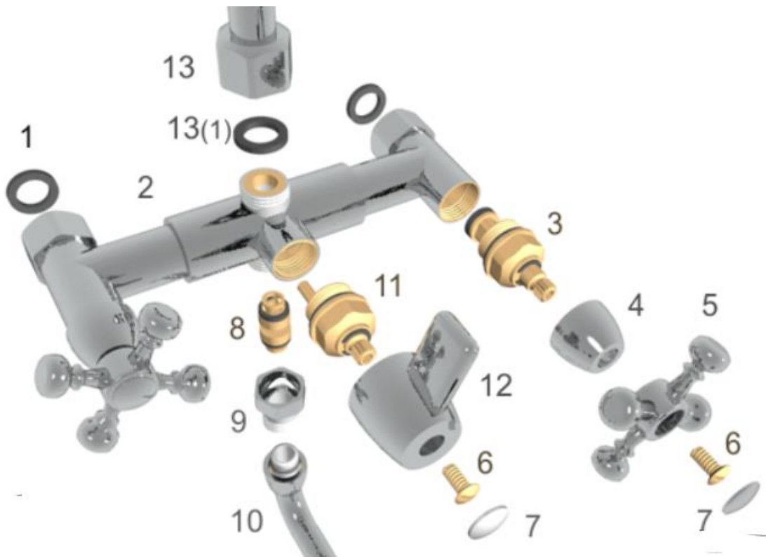
Рис. 3. Складові елементи двовентильного змішувача
