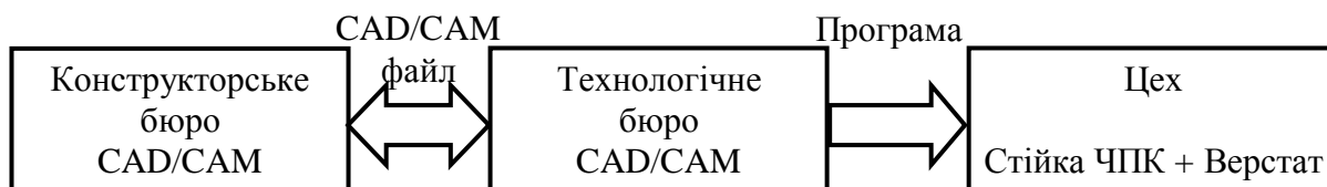
Рисунок 2.1 – Традиційна схема програмування верстата з ЧПК
