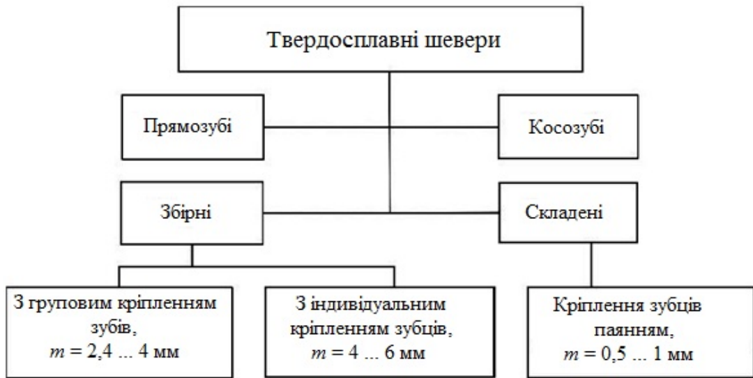
Рисунок 8.11 – Класифікація твердосплавних шеверів
