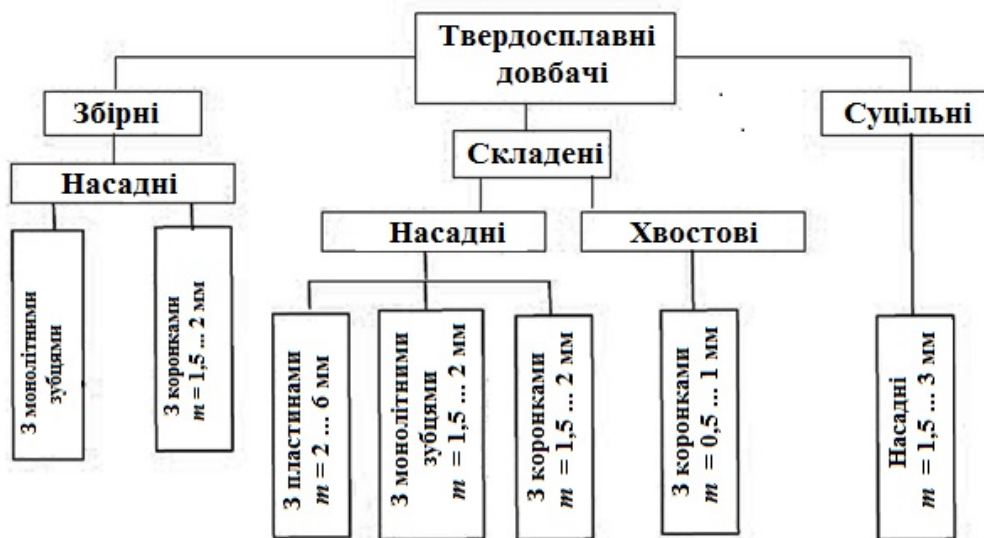
Рисунок 8.9 – Класифікація твердосплавних довбачів
