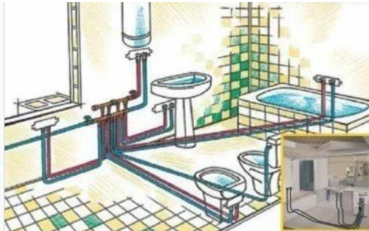
Рис. 10. Підключення санітарних приладів за допомогою колекторів
