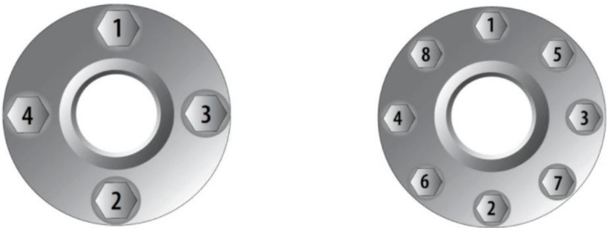
Рис. 8. Послідовність виконання затягнення болтів
