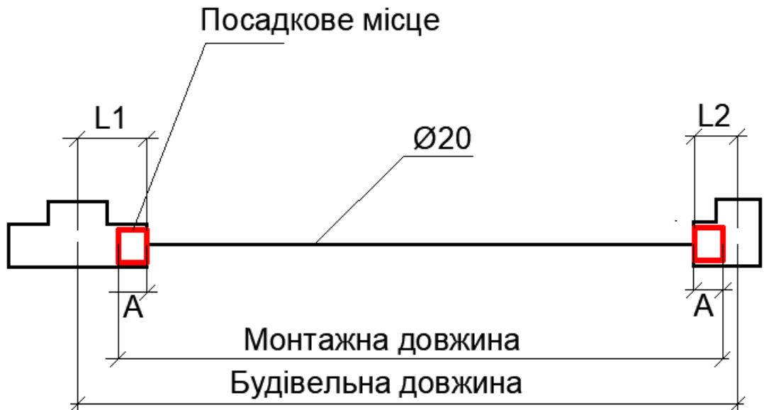
Рис. 1. Визначення монтажної довжини поліпропіленових труб
