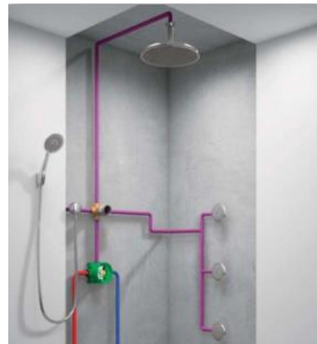
Рис. 13. Зовнішній вигляд змонтованого прихованого змішувача у стіні
