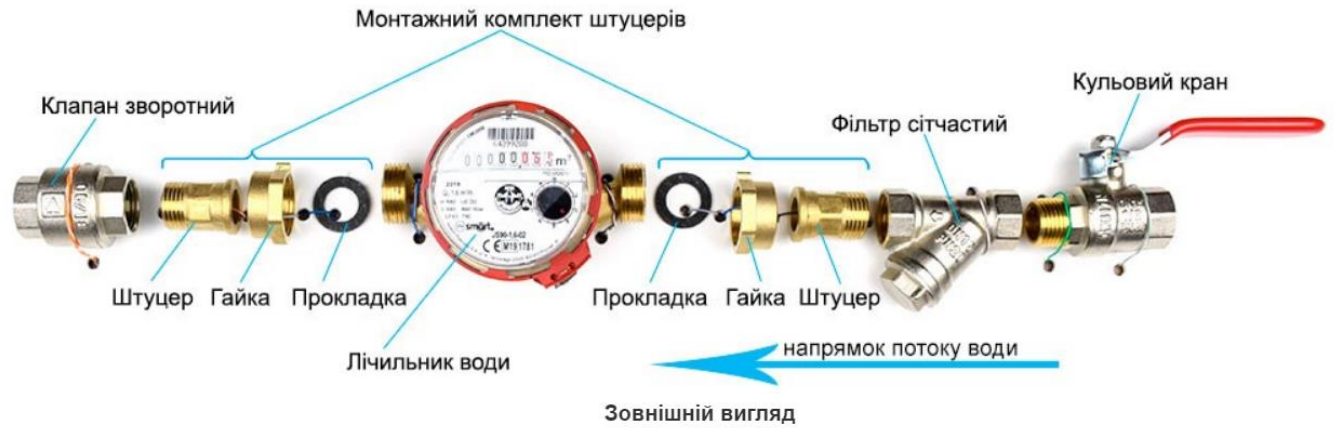
Рис. 12. Послідовність з'єднання елементів квартирного водомірного вузла
